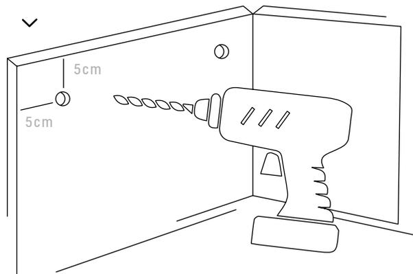
Il est possible de percer les plaques en fonte avec une perceuse normale et une pointe pour l'acier. Le trou doit être de 11 mm, pour permettre l'expansion pendant l'utilisation de la cheminée. Les 2 trous seront positionnés à 5 cm du bord supérieur et à 5 cm de l'extérieur.
